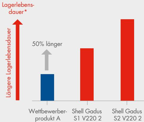
\*Branchenübliche Tests der Schmierfettstandzeit in Fahrzeug-Radlagern (ASTM D3527) bei 160 °C und Belastung im 20-Stundenzyklus bei konstanter Geschwindigkeit. Der Test wird beendet, wenn Temperatur oder Drehmoment den maximal zulässigen Grenzwert erreicht.
