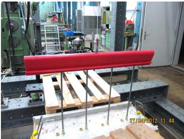
c) Anordnung der Bewehrungseisen mit \varnothing 12 mm n = 4 , a = 200 mm, L = 670 mm
