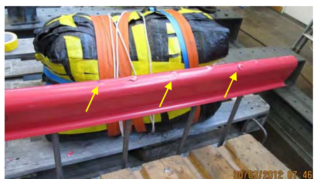
f) Versuche V06-16 und V07-16 (BE \varnothing 16 mm) mit dem gleichen Profil Pfeile: Druckstellen durch den Versuch V06-16
