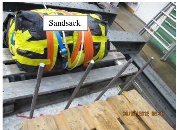
f) Anordnung der Bewehrungseisen mit \varnothing 16 mm n = 4 , a = 200 mm, L = 520 mm
