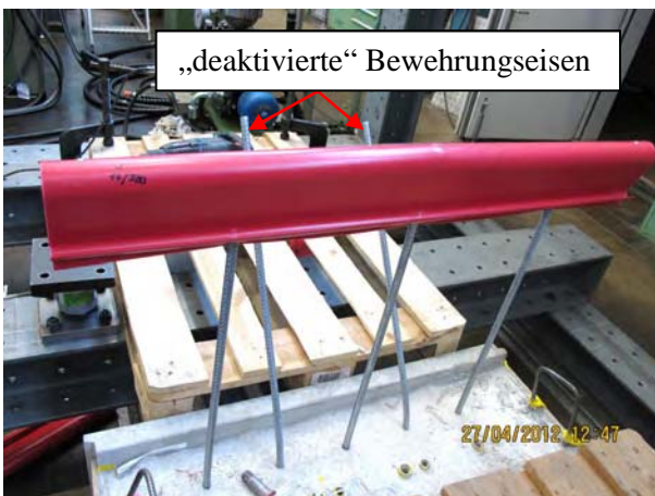
e) Anordnung der Bewehrungseisen mit \varnothing 14 mm für V02/03/04-14, n = 3 , a = 300 mm, L = 650 mm
