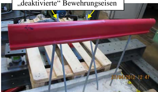
e) Versuch V03-14 (wie Bild d) Foto nach Entfernen des Sackes
