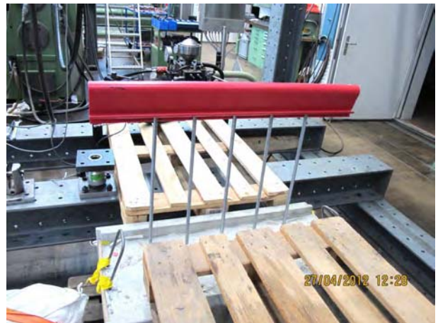
d) Anordnung der Bewehrungseisen mit \varnothing 14 mm für V01-14, n = 5 , a = 150 mm, L = 650 mm
