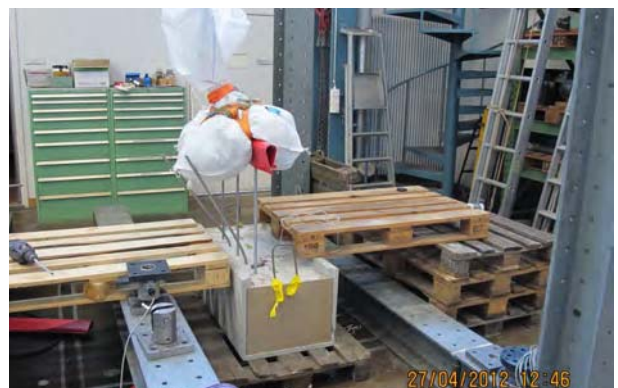
d) Versuch V03-14 (BE \varnothing 14 mm) und BE-Abstand 300 mm
