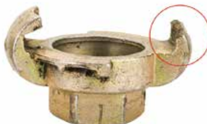
Plagiat aus Fernost (kein Herstellerkennzeichen, minderwertiges Material) – bereits nach kürzester Zeit abgerissene Klaue
