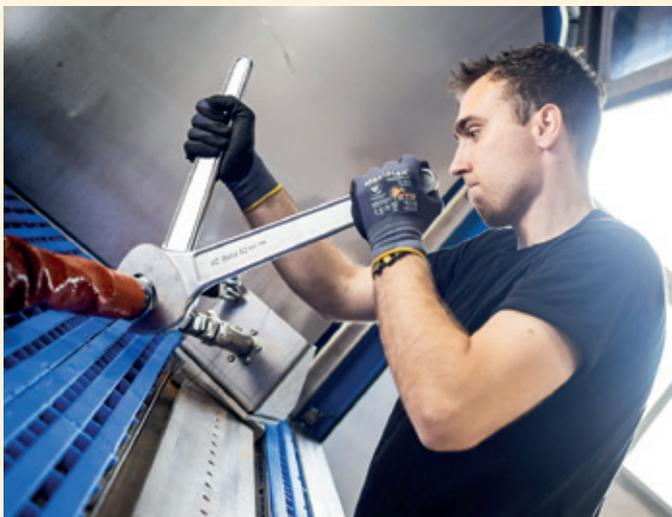
Mit dem Hydraulik-Prüfstand können Schläuche mit einem Durchmesser von 6 bis 50 Millimeter einer Prüfung unterzogen werden.
